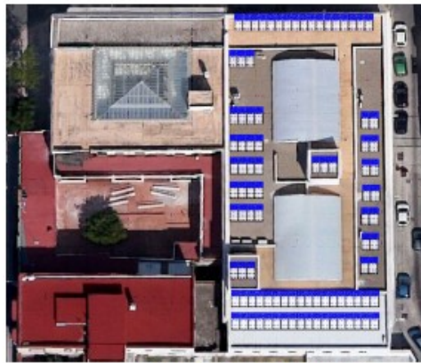
Ilustración 13: Planta de distribución de placas en cubierta
