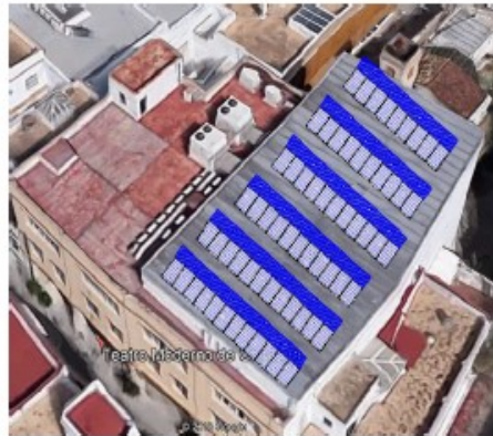
Ilustración 22: Planta de distribución de placas en cubierta
