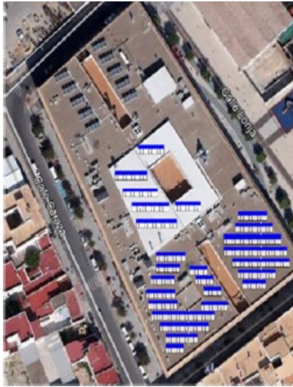
Ilustración 7: Planta de distribución de placas en cubierta
