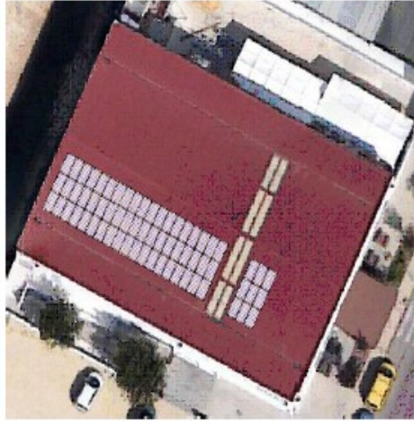
Ilustración 17: Planta de distribución de placas en cubierta
