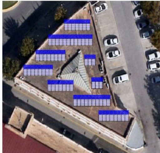
Ilustración 27: Planta de distribución de placas en cubierta
