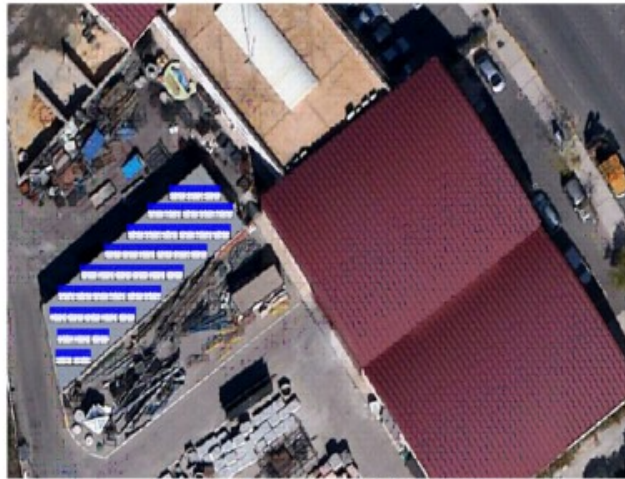
Ilustración 33: Planta de distribución de placas en cubierta
