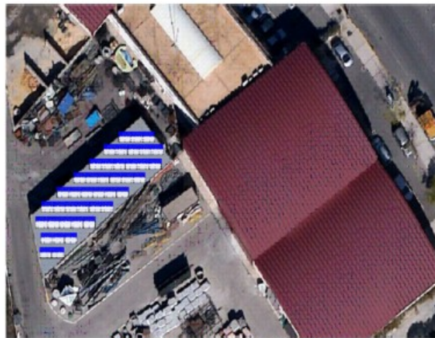
Ilustración 33: Planta de distribución de placas en cubierta
