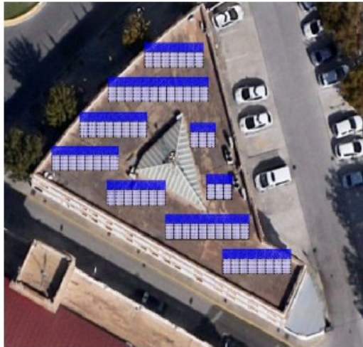
Medida 15. Instalaciones solares fotovoltaicas destinadas a generación eléctrica para autoconsumo (conectadas a red y aisladas) Instalaciones fotovoltaicas destinadas a la generación eléctrica para autoconsumo en edificios municipales de Chiclana de la Fra. (Cádiz)
