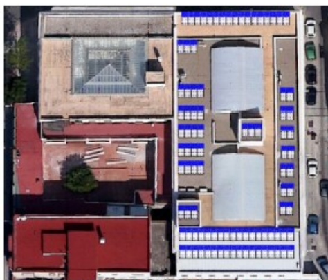
Ilustración 13: Planta de distribución de placas en cubierta
